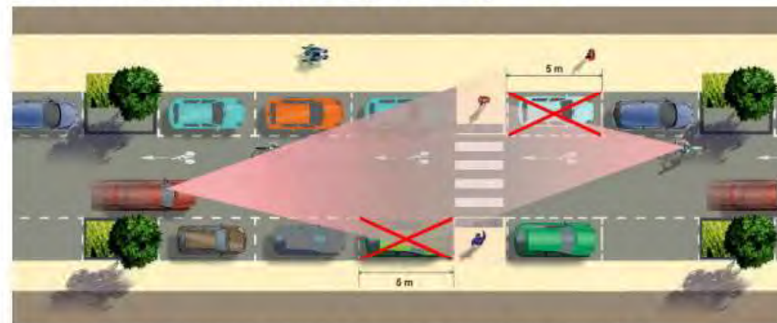
Suppression du stationnement motorisé en amont du passage piéton, bord droit
